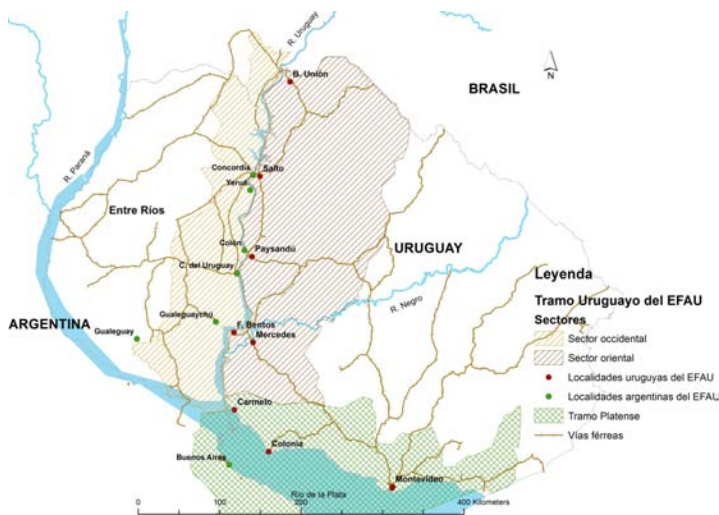
Figura 6. Infraestructura ferroviaria instalada en el tramo uruguayo (año 2013)
